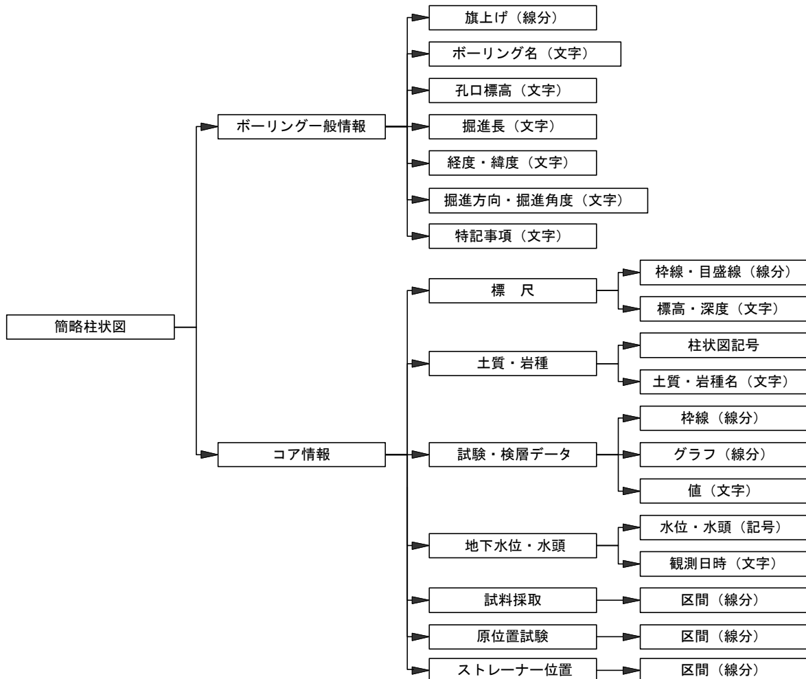
図 7-2 簡略柱状図の要素構成
